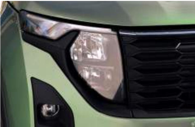
REFLEKTORY PRZEDNIE HALOGENOWE - ZE ŚWIATŁAMI DO JAZDY DZIENNEJ LED Wypożenie standardowe wersji z napędem elektrycznym Wypożenie opcjonalne dla pozostałych wersji
